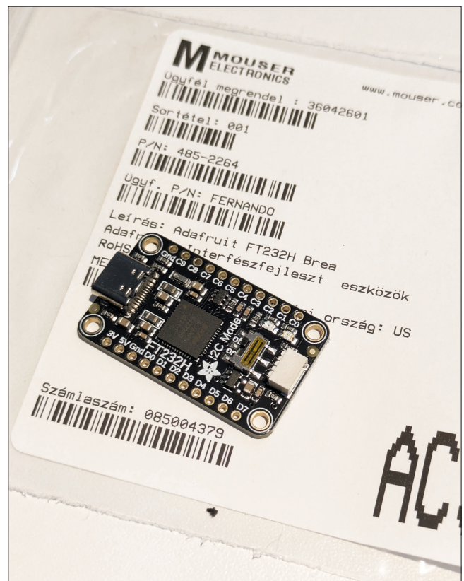
Dieses Board agiert als Interface zwischen .NET-Code und Hardware der realen Welt (Bild 2)
