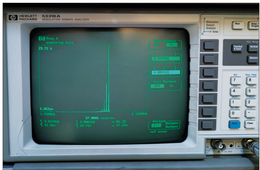
Die Entstehung von drei Höckern zeigt Instabilität (Bild 4)
